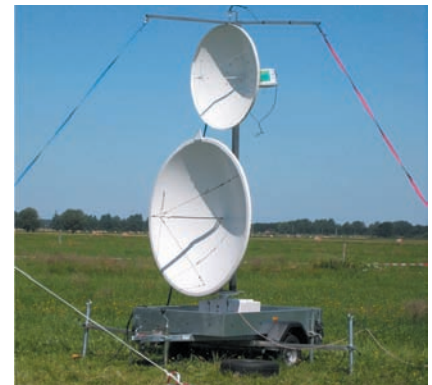
Abb.1: Radargerät zur Verfolgung der Flüge einzelner Bienen.
