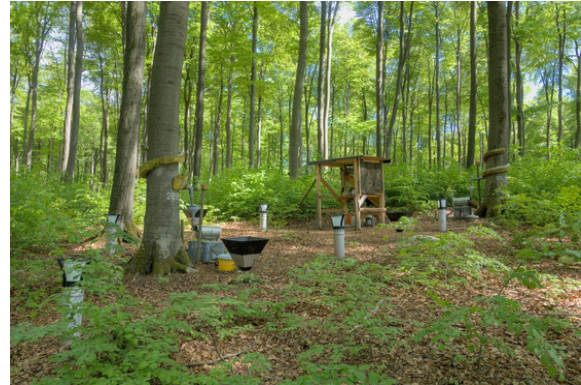
Abb. : Sammelgefäße zur Erfassung der Deposition und des Streufalls auf der Buchen-Dauerbeobachtungsfläche Neuhäusel. Auch der Bodenzustand und das Bodenwasser werden regelmäßig untersucht. Die Fläche ist Teil des EU-weiten Monitoringprogramms ICP-Forests zur Überwachung von Waldökosystemen.
